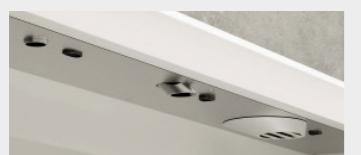
Sistema electrónico de sensórica, activado por un sensor electrónico láser de sensibilidad ajustable.
